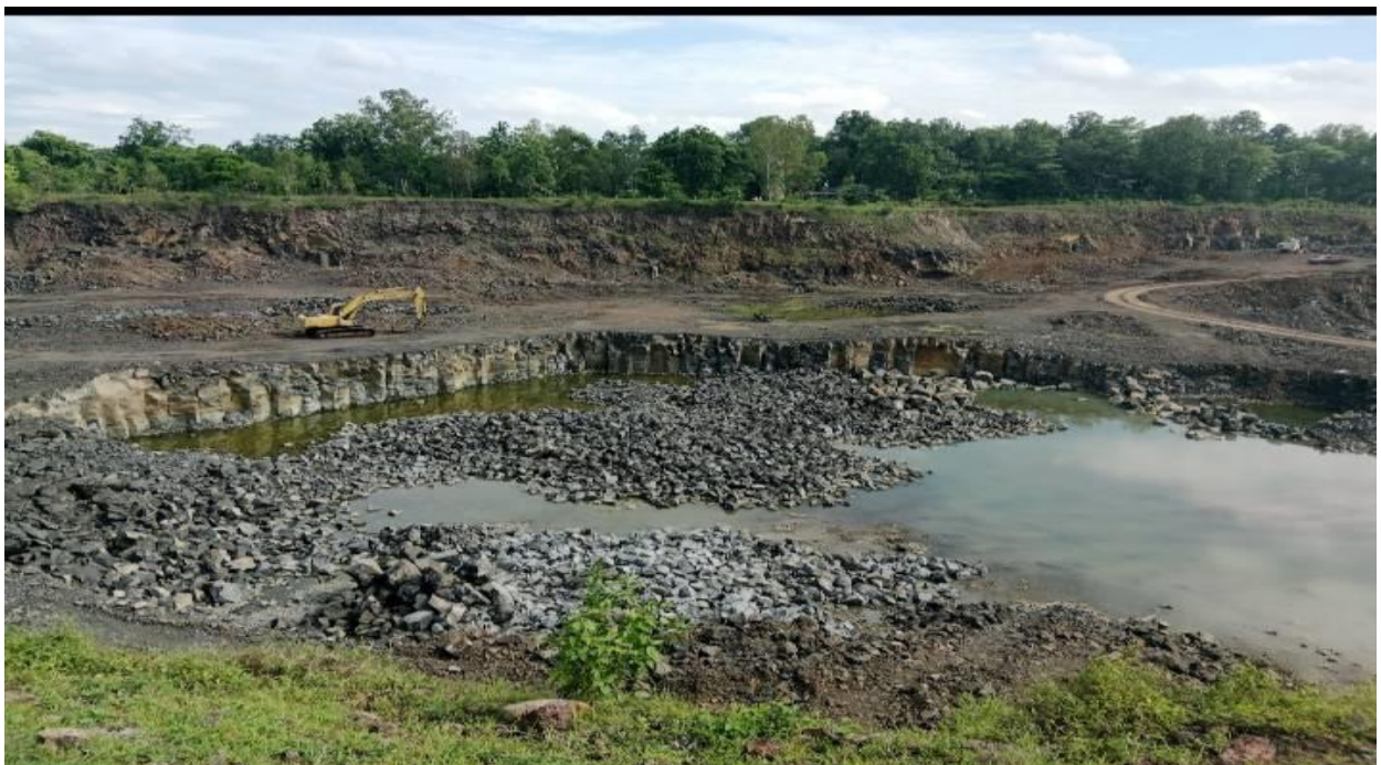
รูปที่ 2 ทำเหมืองแบบจั่นบันไดและปรับความลาดชันไม่เกิน 45 องศา
