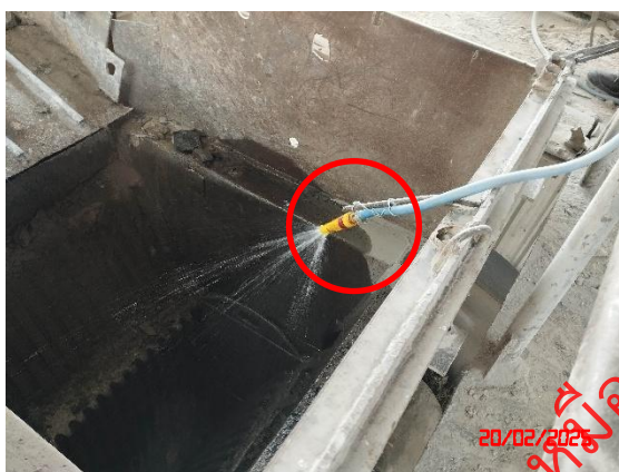
ระบบระบายน้ำบริเวณแทงก์น้ำเน็ดฝุ่นละออง
